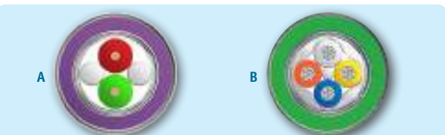
图13: PROFIBUS电缆+FE (A), PROFINET电缆+FE (B) 的横截面
