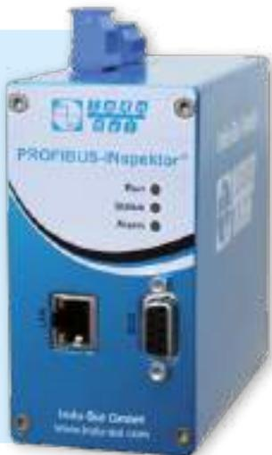
紧凑型 INspector® - PROFIBUS-INspector® NT 是用于 PROFIBUS 网络的分布式数据收集器的最简单解决方案。该版本无需任何特殊配置即可立即投入使用，以收集网络中所有典型的逻辑质量参数。
