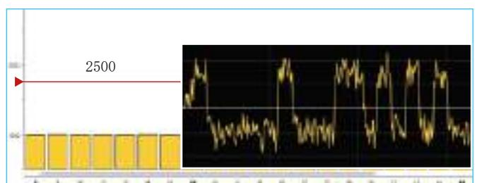
图 10：网段终点测量 - 弱信号值
