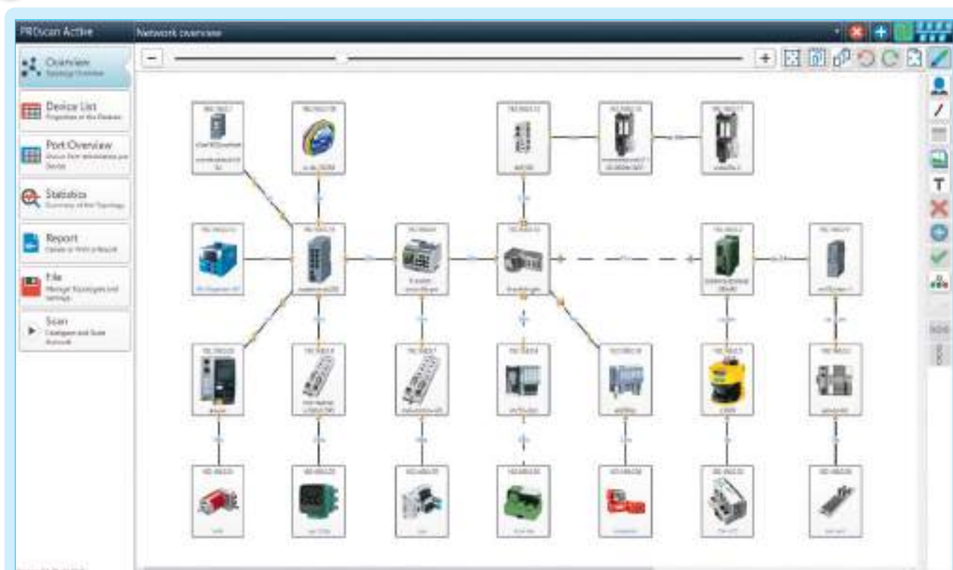
图15:PROscan® Active V2——清晰显示的网络拓扑结构
