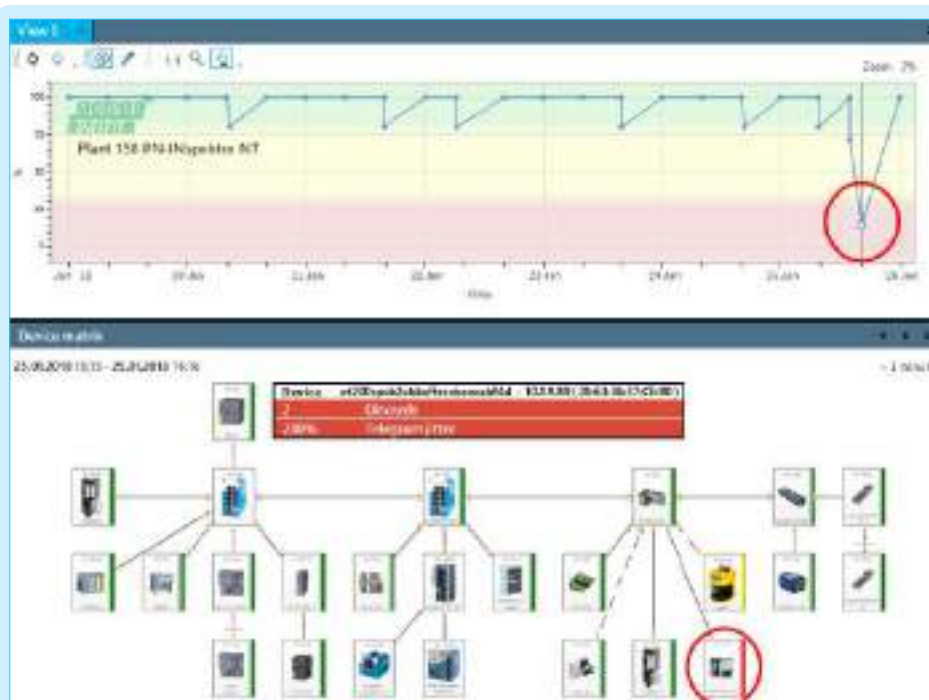
图28:PR0manage® NT中的中心拓扑检测
